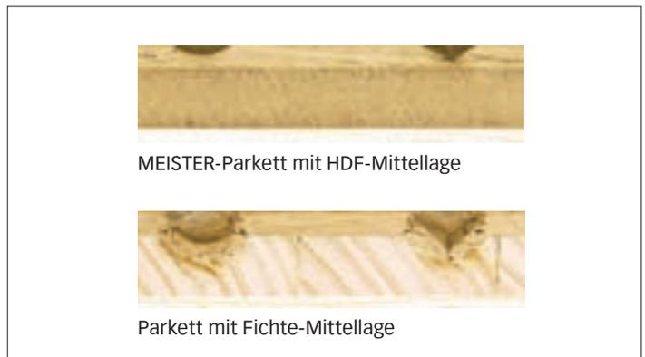
Falltests mit Kugel (links) und Keil (rechts) aus 90 cm Höhe auf Parkett mit 3,6 mm Eiche-Deckschicht
