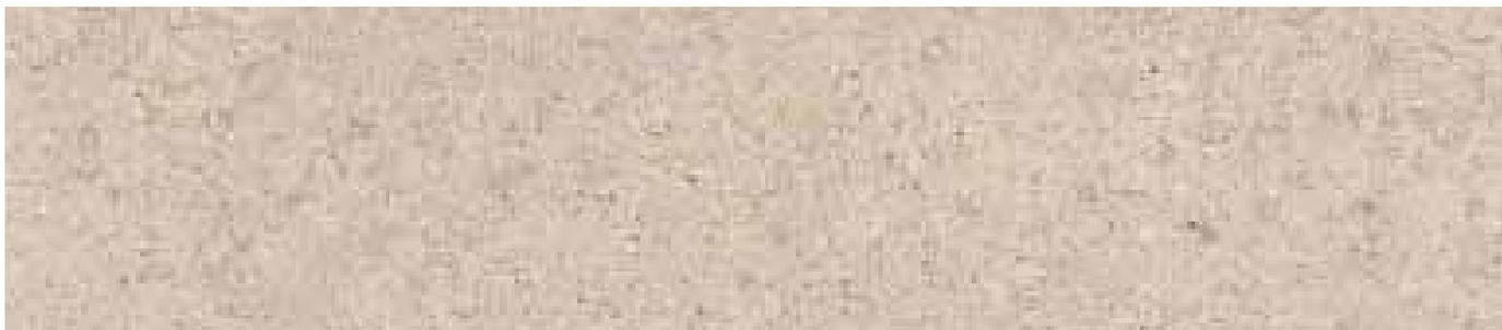
Dieser graubraune Kalkstein trägt ein großes Stück Erdgeschichte in sich, denn er besteht zu ungefähr 75 % aus Schalen von Muscheln und anderen Kleintieren. Er ist mit dem Fossil SKL vergleichbar, allerdings wird er gegen das Lager (also gegen die Schichtung) geschnitten. Während sein Bruder, der SKL, größtenteils grob geschliffen (C 60) zum Einsatz kommt, wird der SKD mehrheitlich fein geschliffen (C 320) auf die Baustelle geliefert.
