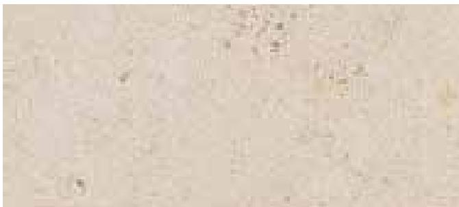
Gesteine weisen aufgrund ihrer geologischen Entstehung verschiedene Richtungen auf. Dementsprechend schneidet man sie „im Lager“ (parallel zur Schichtung) oder „gegen das Lager“ (quer zur Schichtung). Bavaria Travertin wird „gegen das Lager“ geschnitten und erlangt dadurch eine Oberfläche, die dem römischen Travertin sehr ähnlich ist. Der sehr helle bis gelbbraune Stein, der aus bestimmten Schichten in Jura-Steinbrüchen in Bayern stammt, wird vorzugsweise fein geschliffen als Baustein verwendet.
