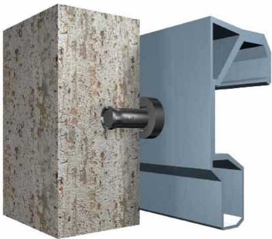
**Hinterschnitt-Technik.** Verglichen mit der konventionellen Dornanker-Befestigung weist die Hinterschnitt-Technik eine drei- bis fünffache Tragfähigkeit auf. Durch die zentralere Platzierung in der Rückseite der Steinplatte werden Biegespannungen im Stein deutlich reduziert und der Einsatz von dünneren Fassadenplatten ermöglicht.
