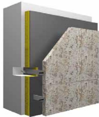
**Dorngelagerte Natursteinfassade:** das traditionelle Fassadensystem mit 10-mm-Fugen. Hierfür werden die Platten im Bereich der horizontalen oder vertikalen Fugen mit Bohrungen zur Aufnahme der Ankerdorne versehen. Das stabile System kann innen wie außen und mit sämtlichen Steinen aus dem Sto-Sortiment realisiert werden.
