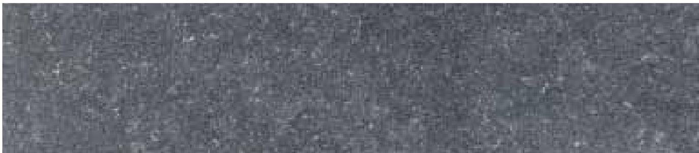
Der Gabbro Super Dark, der in Zimbabwe abgebaut wird, ist kein Impala, auch wenn hier mitunter Verwechslungsgefahr bestehen dürfte. Er ist noch dunkler („Absolute Black Zimbabwe“), mit einer Rohdichte von 3 ein veritables Schwergewicht und mit einer Druckfestigkeit von bis zu 252 N/mm<sup>2</sup> hart im Nehmen. Seine Bedeutung für die deutsche Architektur ist derzeit noch überschaubar, in Japan hingegen wird er in großen Mengen zur Fassadenbekleidung eingesetzt.
