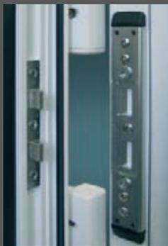
**Bandseitensicherungen** inkl. Aushebesicherung verhindern das gewaltsame Ausheben und Aufquetschen der Tür.
