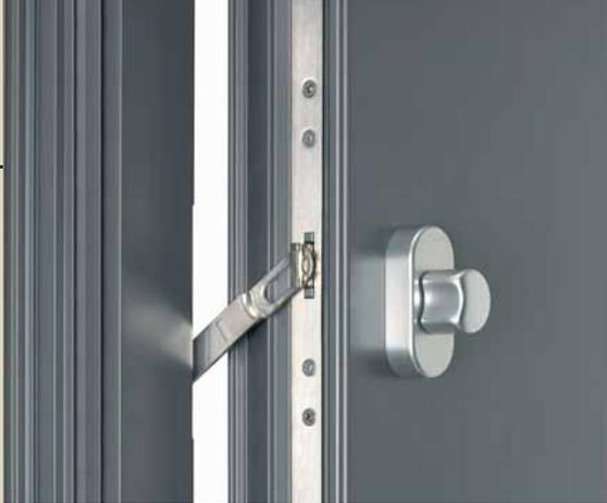
*Die optional lieferbare 7-fach-Verriegelung wird auf Wunsch mit einem integrierten Sperrbügel ausgestattet, der sich von außen bei geschlossener Haustür komfortabel mit dem Schlüssel über den Hauptschließzylinder entriegeln lässt. Die Öffnungssperre ermöglicht es, Besucher zunächst in Augenschein zu nehmen, bevor die Tür vollständig geöffnet wird.*
