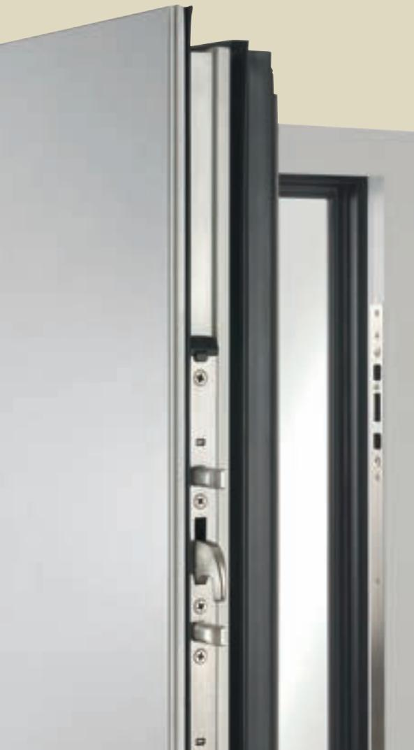
*Das 7-Punkt-Schwenriegel-Bolzenschloss mit durchgehender Schließleiste in Edelstahl sichert mit zwei stabilen Stahl-Schwenriegeln, vier Stahl-Rundbolzen und einem rechteckigen Stahlriegel zuverlässig gegen Ein- und Aufbruch.*
