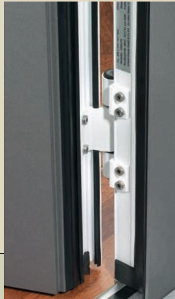
*Die dreiteiligen, dreidimensional verstellbaren, ausreißfesten Türbänder der GRAUTE-Therm-90-Haustür gewährleisten eine dauerhafte feste Verbindung von Rahmen und Flügel und überzeugen durch eine formschöne Optik, Robustheit und Stabilität. Die Türbänder werden von außen unsichtbar mit jeweils sechs massiven Schrauben im Türfalz befestigt.*
