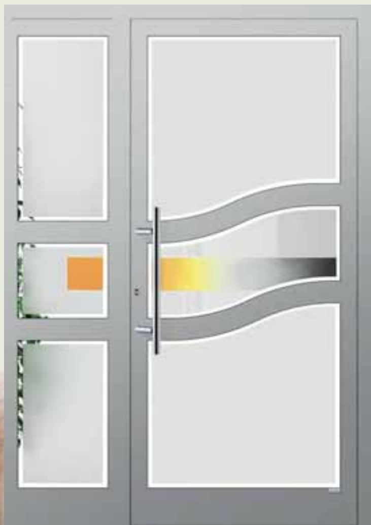
T 114 verschweißt , RAL 9006 weißaluminium, Glas L 01 (Float in unterschiedlicher Intensität teilmattiert mit mehrfarbiger Lackierung) Griff 1982 Edelstahl 600 mm
