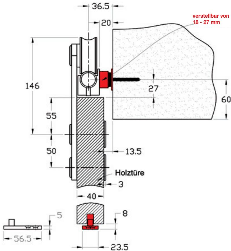
Einzelteile für Holz- und Ganzglastürbeschläge 8/10 mm
