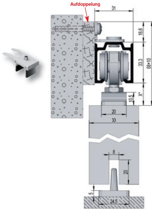
Bei Türstärken ab 30 mm muss hinter der Laufschiene eine Holzleiste angebracht werden (Aufdoppelung).
