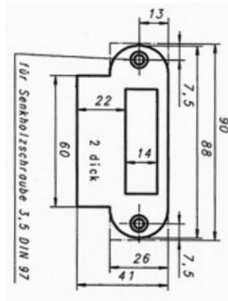
Lappenschließblech abgerundet, 90x26x41x2 mm
