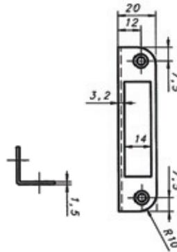
Winkelschließblech abgerundet, 90x20x20x1,5 mm
