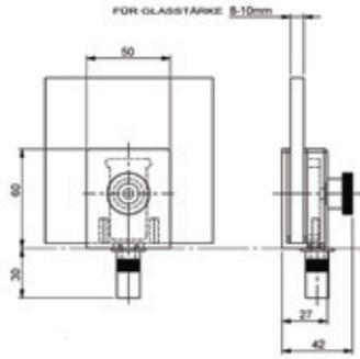
Feststeller für 2-flügelige Glastüren Standflügel, inkl. Aufnahmebuchse mit Federverschluss
