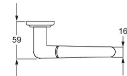
Alle Modelle in Ö-Norm (mit  $\varnothing$  8,5 mm Stift, WC-Riegel mit  $\varnothing$  7 mm Stift)
