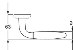
Alle Modelle in Ö-Norm (mit  $\varnothing$  8,5 mm Stift, WC-Riegel mit  $\varnothing$  7 mm Stift)
